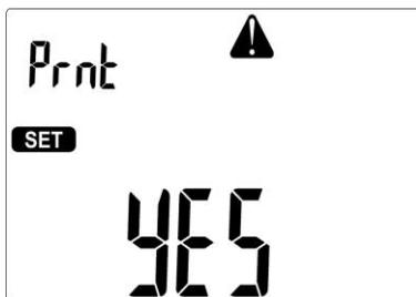
Con los botones ▲, ▼ ajustar el funcionamiento del medidor con la impresora (**YES**) o sin (**NO**).
