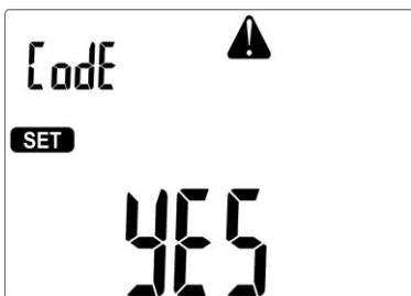
Con los botones ▲, ▼ ajustar el funcionamiento del medidor con el lector de códigos de barras (**YES**) o sin (**NO**).
